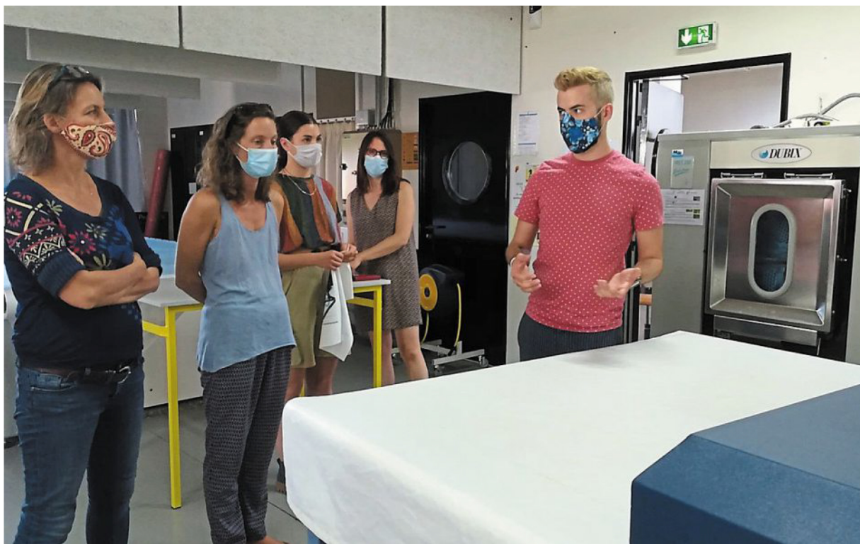
Le responsable technique, Quentin Pérès, explique comment fonctionne la presse de découpe au groupe venu visiter le FabLab eMode. Derrière les participantes, se trouve la table de découpe textile. Derrière le responsable technique, trône la laveuse industrielle, qui permet de laver 60 m de coton à 120 g en une seule fois.
